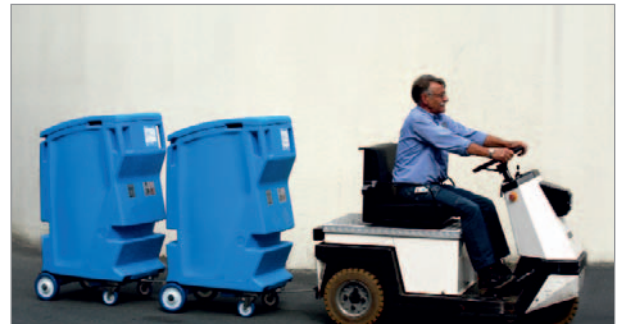
So können zahlreiche Fässer hintereinander transportiert werden. Hinweis: Es dürfen maximal 700 kg angehängt werden. Multiple drums can be transported at the same time. Note: Maximum load to be put behind Drumtainer 700 kg.
